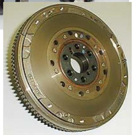
El volante lleva en su parte exterior una corona dentada que para que engrane el piñón del motor de arranque.
