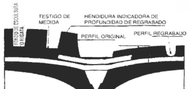
(1) SE HACE EN EL PUNTO MAS DESGASTADO DEL NEUMATICO Y SEGUN LAS TABLAS DE CADA FABRICANTE NOS DA LA PROFUNDIDAD DE REGRABADO
