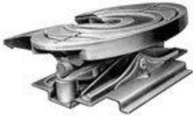
Se utiliza para las unidades que trabajan en patio movilizandolo constantemente los semirremolque, la quinta rueda puede subir el semirremolque con una bolsa de aire y evita que el operador este subiendo y bajando las torres del semirremolque.
