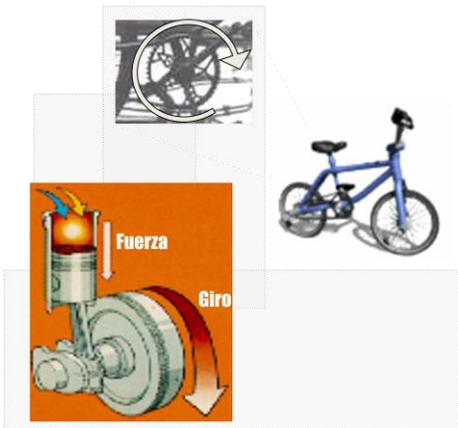
**TORQUE:** Se define como una fuerza aplicada por medio de una palanca para vencer una resistencia al giro un ejemplo es la fuerza que hace el ciclista sobre el pedal.
