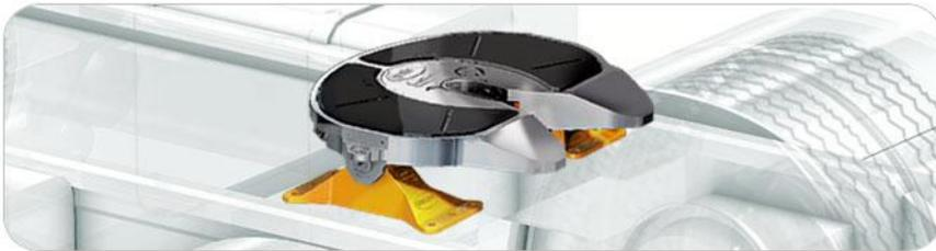
Esta se ubica en el bastidor en determinada distancia y no se puede mover tan solo soltando los pernos que la sujetan.
