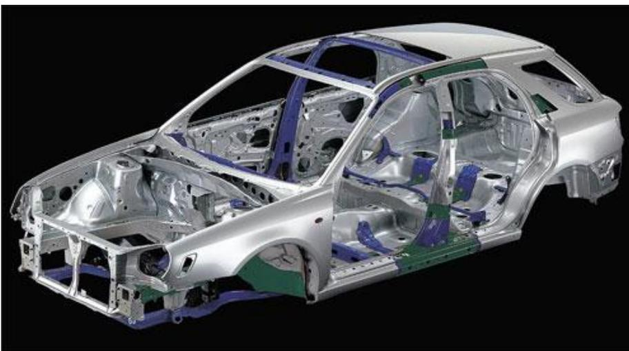
Este diseño de carrocería recibe el nombre de "monocasco" carece de bastidor, estando constituido por partes que forman un casco, su estructura requiere de puntas de bastidor donde se apoya el motor y se ajusta a la carrocería.
